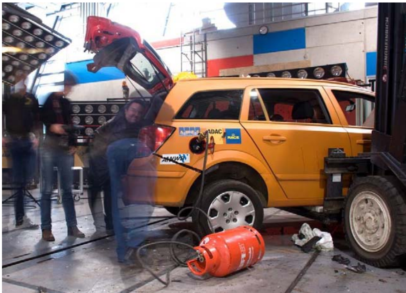
Figura 6: recarga del depósito de Autogas después de la prueba de choque.
