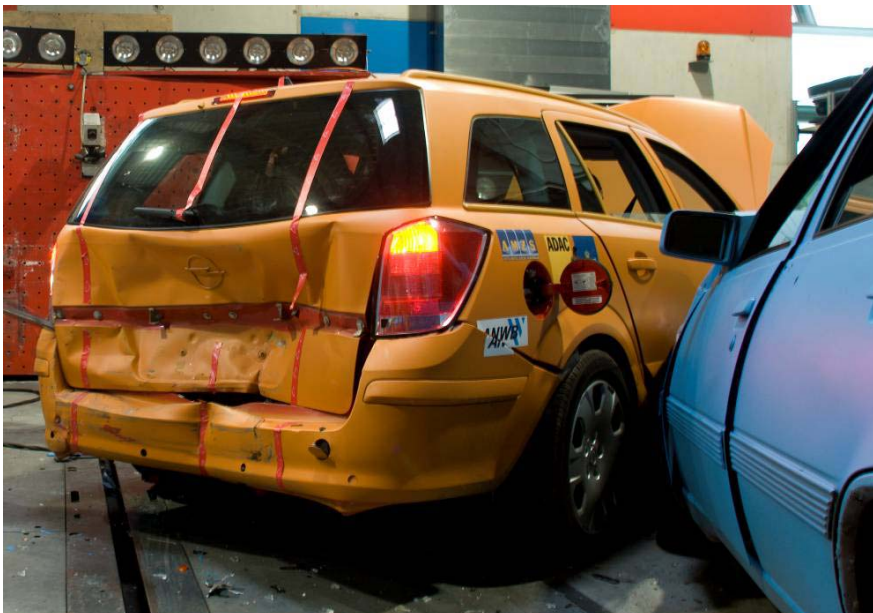
Figura 4: vista de la parte trasera del Astra después de la prueba.
